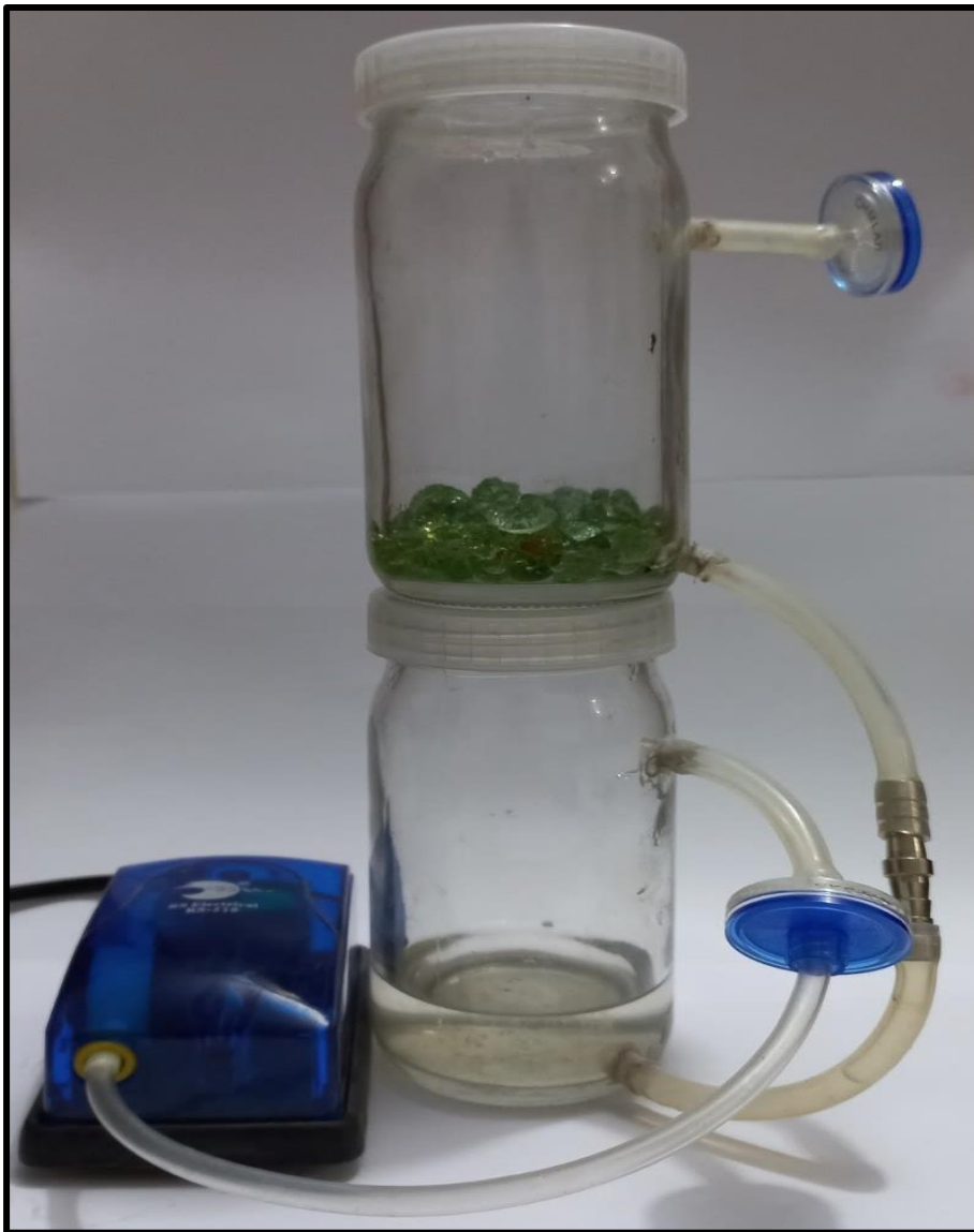
شكل (8) مُفاعل الغمر المؤقت المُصنع في مختبر الأنسجة النباتية / قسم البستنة وهندسة الحدائق / جامعة ديالى
