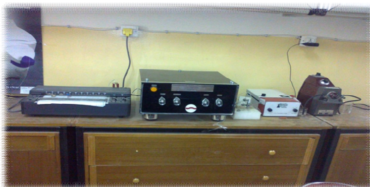
شكل (1) صورة فوتوغرافية للمنظومة المستخدمة لرصد البريق الكيميائي
