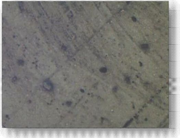
الشكل (5a) يوضح صورة لعينة (96% Polyester +4% Alumina) قبل حدوث الانهيار الكهربائي.
