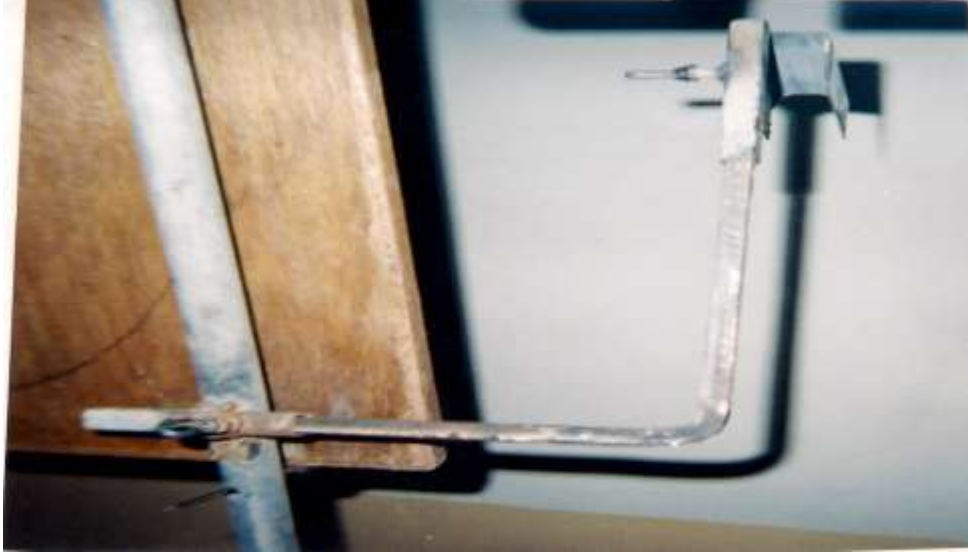
شكل (٧) يظهر تفاصيل مسند الرأس لضبط نقطة ومستوى واتجاه البصر وكيفية تثبيته في الحماله
