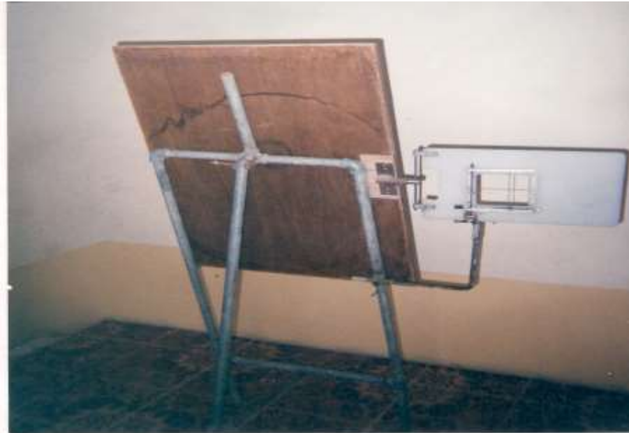
شكل (٤) يظهر وضع الشباك المستهدف من الخلف وعلاقات ترابطه مع لوح الرسم والحاملة
