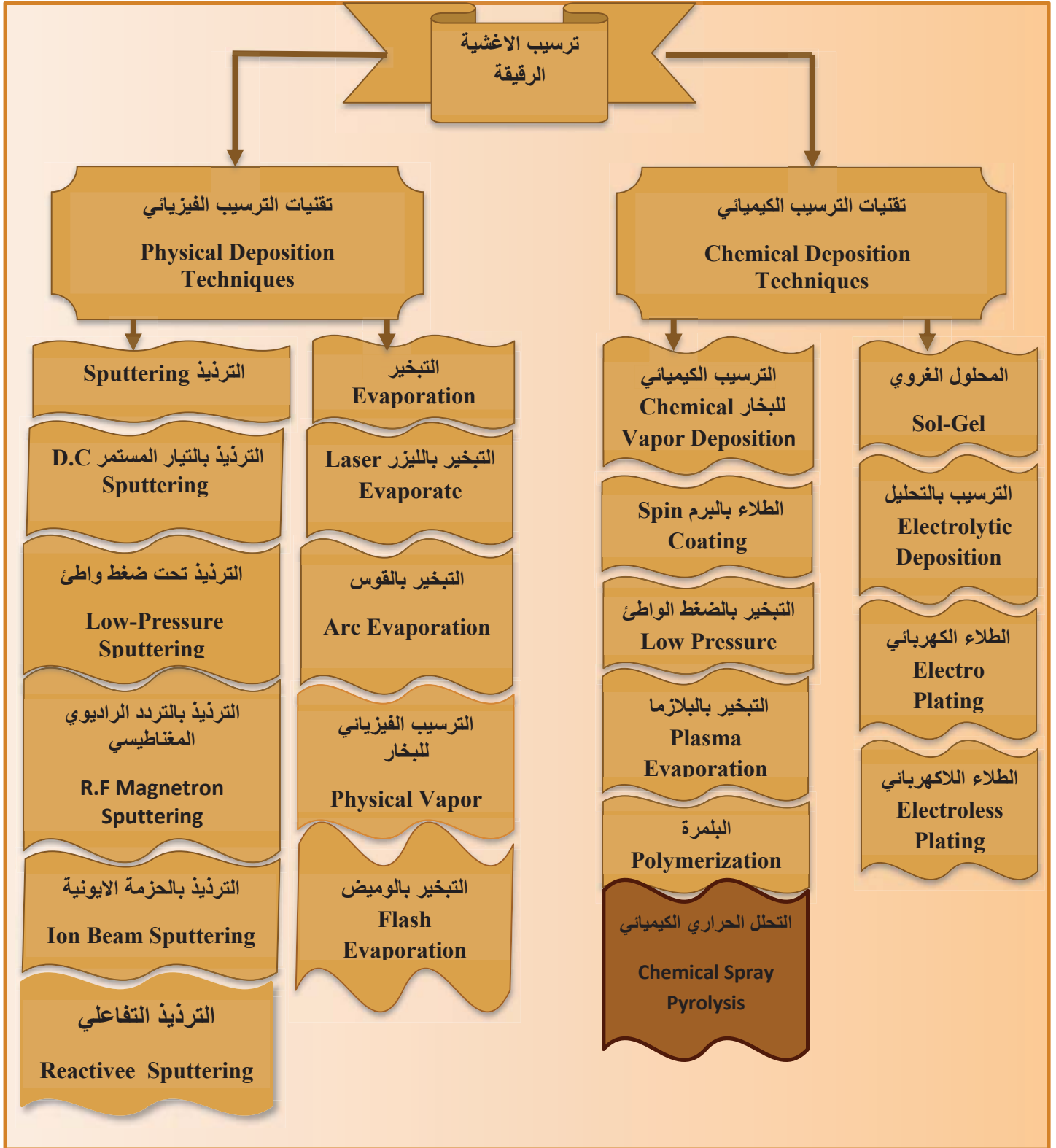
الشكل (1-1): مخطط توضيحي لبعض تقنيات تحضير الاغشية الرقيقة [9].
