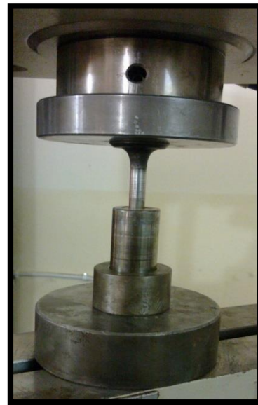
الشكل (1) يبين القالب المستخدم في عملية الكبس.
